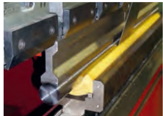
PU-Polster eignen sich gut für Radien- und U-Kantungen, u.v.m.
