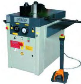
Winkelbieger 22 und 40 to Druckleistung
