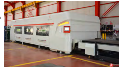
Faser-Laser-Schneidanlagen Strahlenübertragung über flexiblen Lichtwellenleiter
