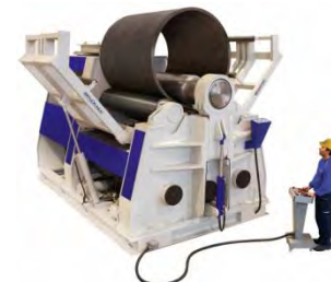
3- und 4-Walzen-Blecheinrollmaschinen Manuell, Motorisch und Hydraulisch
