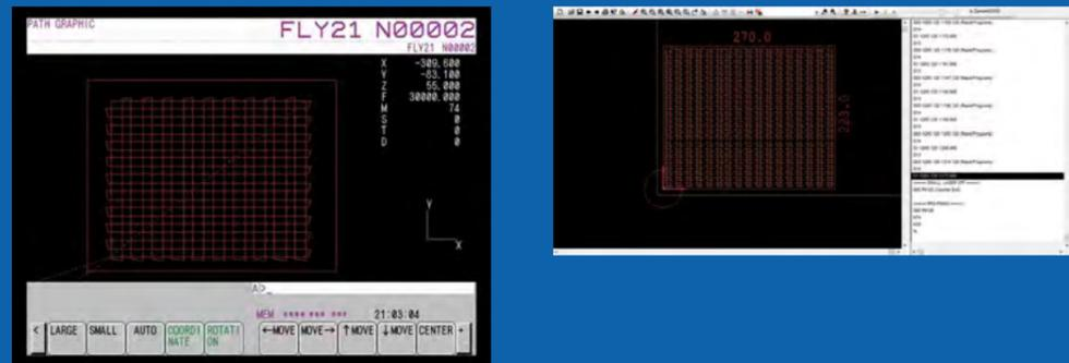
Durch exaktes Zu- und Abschalten des Laserstrahles ist das Schneiden ohne eine Z-Achs Bewegung des Schneidkopfes möglich. Der Schneidkopf fährt die Blechtafel reihenweise ab. Enorme Zeitersparnisse sind das Resultat.
