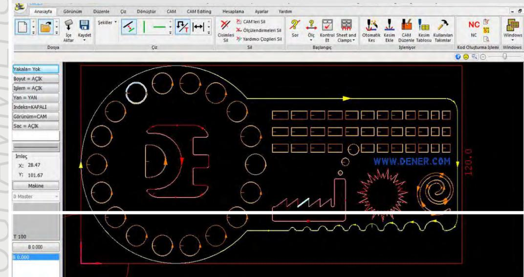
Metalix bietet mit "cncKad" vielseitige CAD/CAM Funktionen für die Blechbearbeitung. Die fortschrittliche Technologie vereint Zeichnen, automatische und manuelle Bearbeitung, automatische Verschachtelung, leistungsfähige NC Erstellung, Grafiksimation und Maschinenkommunikation (DNC).
